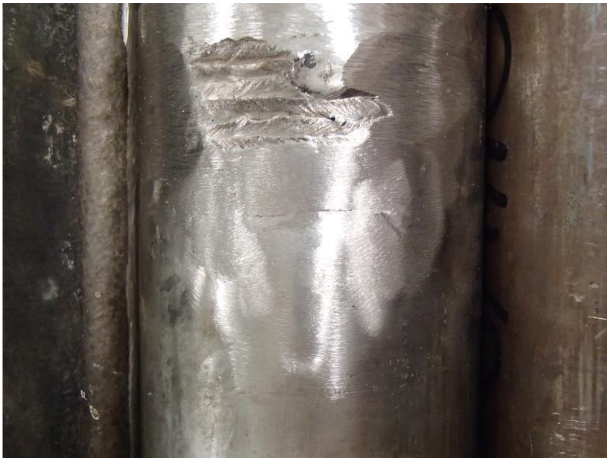
Figur 5. Ett annat exempel där man valt att slipa påsvetsningen ännu mer jämn, men ändå behållit en oslipad del för att underlätta framtida av lokaliseringsmöjligheter.
