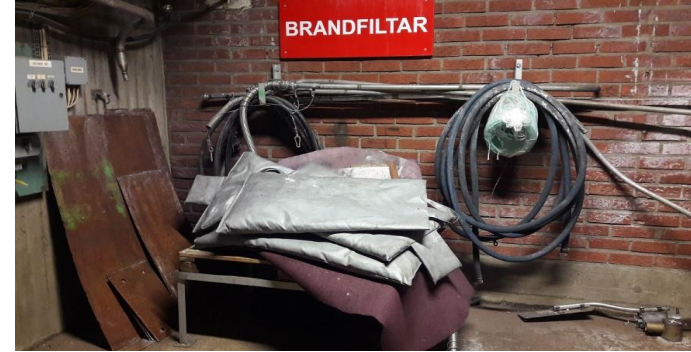
Brandfilter som används för täckning av löprännor vid uh-arbete i området kring löprännor.
