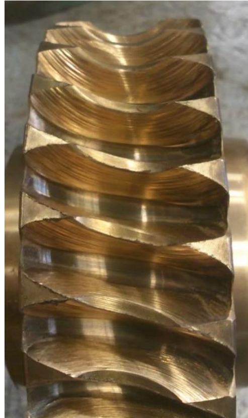
Figur 15. På bilden ses en tydlig förslitning på snäckhulets kuggar. Där snäckskruvens kuggar haft kontakt vid transmission har slitage inträffat.
