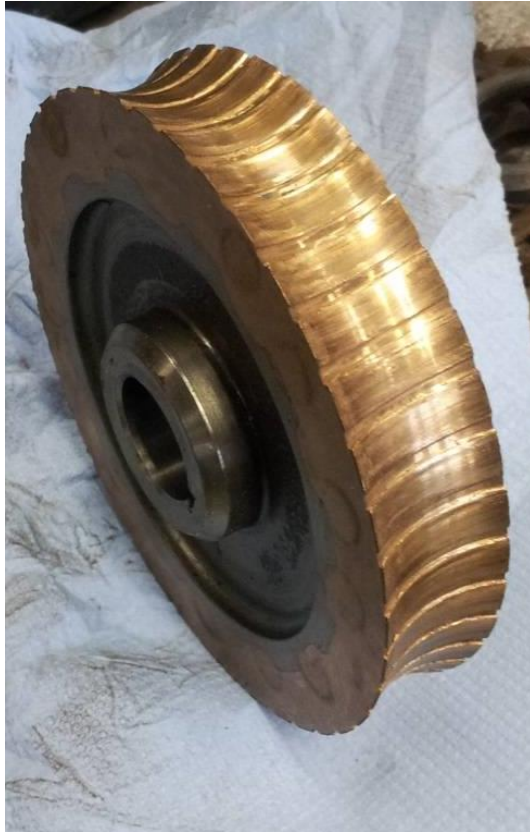
Figur 14. Bild på ett snäckhjul där samtliga kuggar utsatts för kuggbrott. Ytutmattning och höga påfrestningar har orsakat kuggbrott.
